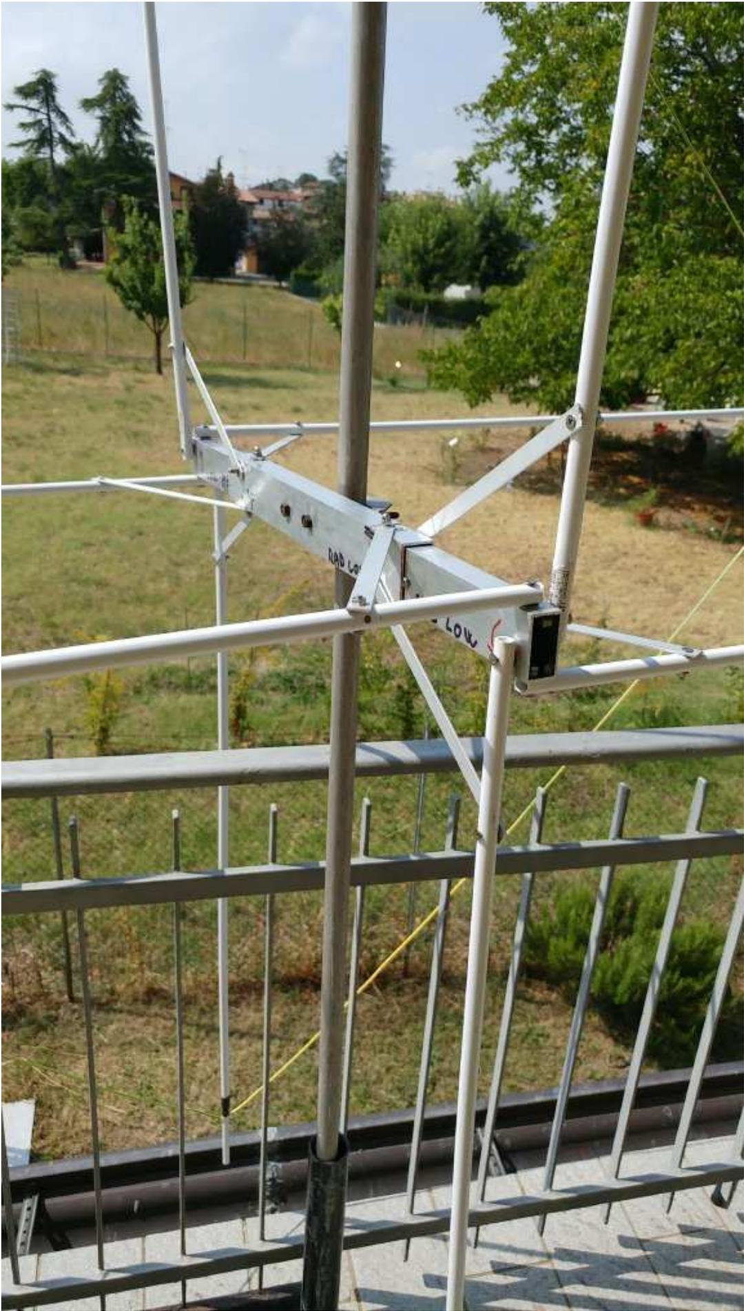
Circa l'aumento di segnale che si ottiene usando la giusta polarizzazione piuttosto che quella sbagliata, valutato con lo S-meter della radio, esso è di circa 2 punti.
