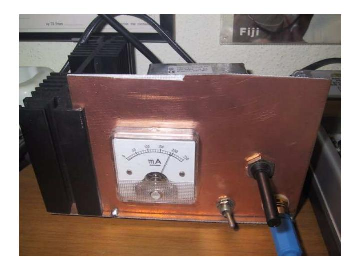
Anziché il trimmer ho usato un commutatore con resistenze fisse
