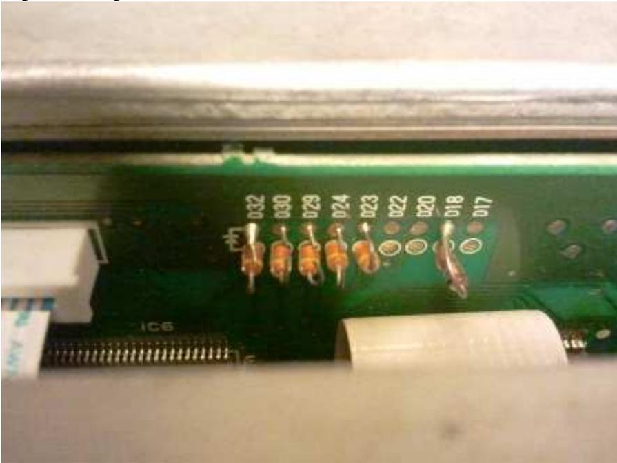
Ora, tagliare i diodi D30 D29 D23 e inserire un diodo 1N4148 o equivalente, nella posizione D22.
